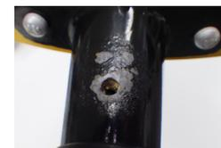
〈水抜き穴に水がたまり、内部がサビた状態〉
