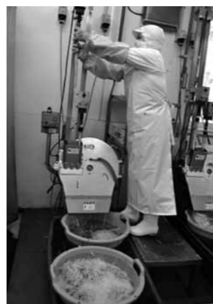
ゴボウをささがきにする工程。1本1本を人の手でゴボウを挿入し、ささがきしていきます。
